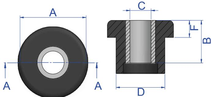
Nous recommandons l'emploi de rondelles supérieures, lorsque la surface d'appui ne peut pas couvrir la totalité de la surface du caoutchouc. Les rondelles sont fournies sous demande.
